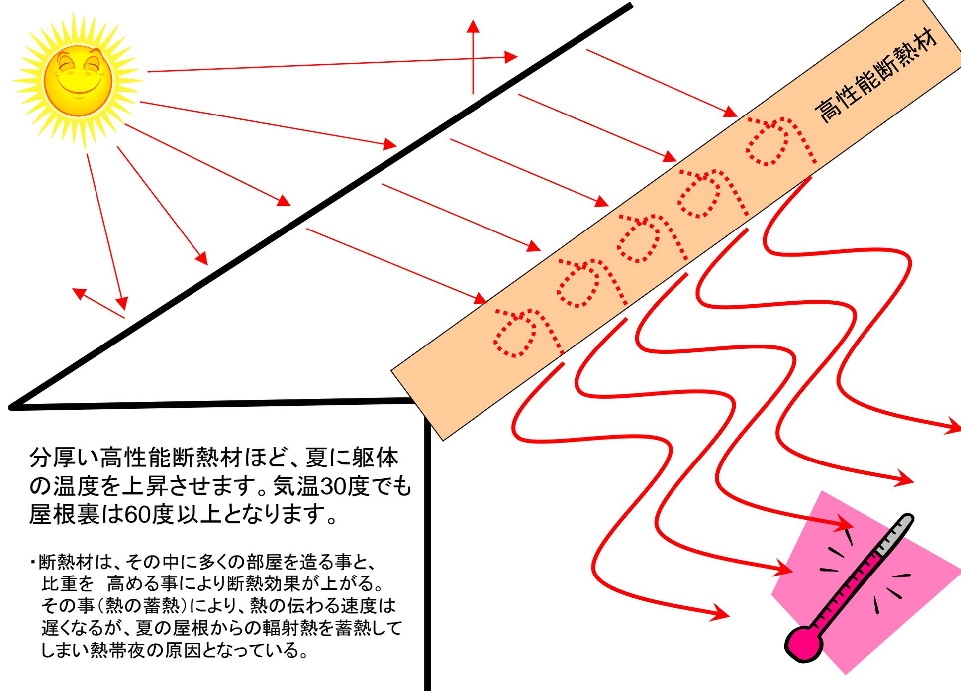
分厚い高性能断熱材ほど、夏に躯体の温度を上昇させます。気温30度でも屋根裏は60度以上となります。
