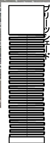
各シェードの構造 折り畳みの状態
